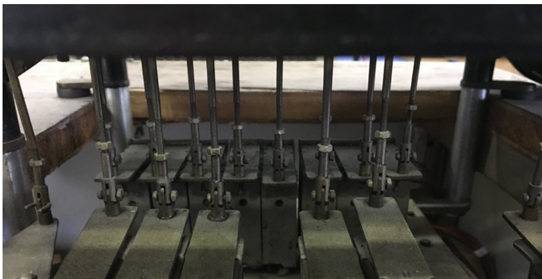
Az eredmények kiírását végző billentyűk alatti rudazat. A szerző felvétele
