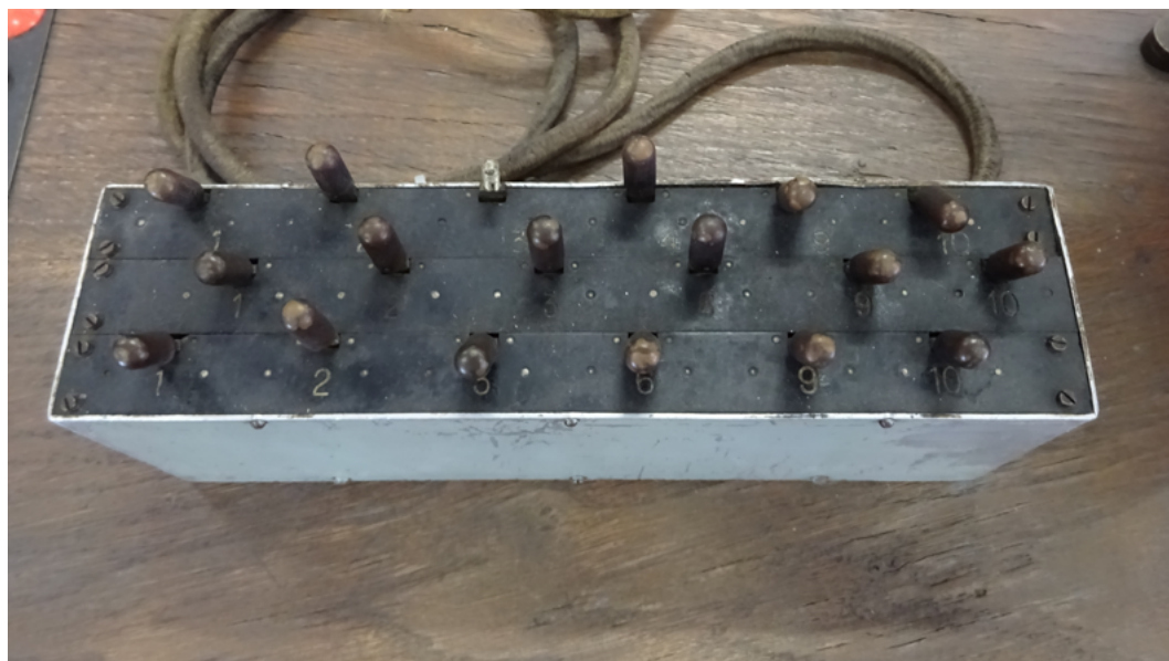
A program futását megállító berendezés. A szerző felvétele
